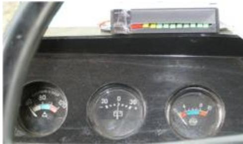
**Рис. 1. Расположение вычислительного прибора контрольно-сигнальной системы на панели приборов тягово-транспортного средства**
