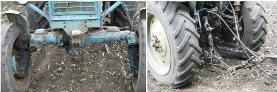
**Рис. 2. Расположение датчиков ускорений на переднем и заднем мостах тягово-транспортного средства**
