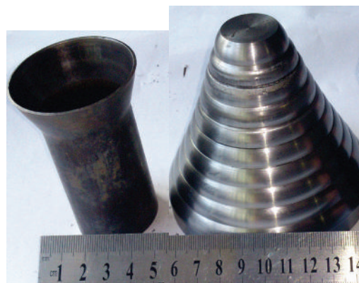
Рис. 11. Здеформована заготовка та зпрофільований конусний пуансон
