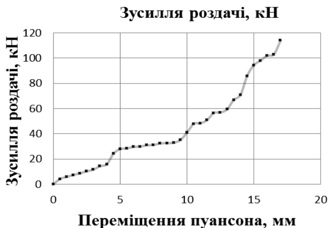
Рис.6. Залежність зусилля роздачі від переміщення пуансону.
