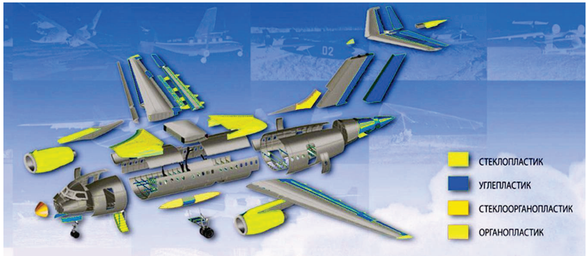
Рисунок 3 – Применение ПКМ в конструкции самолетов Ан-148/158
