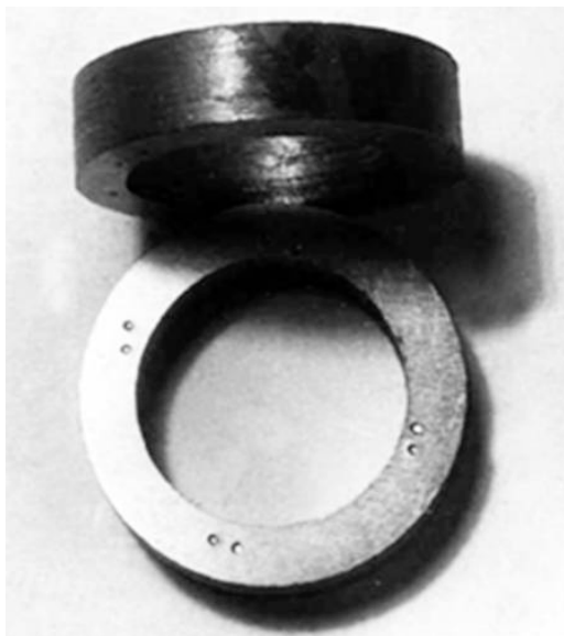
Рисунок 5 – Тарировочные стальные образцы
