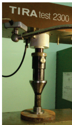
Рис. 9. Оснащення на випробувальний стенді TIRA test 2300
