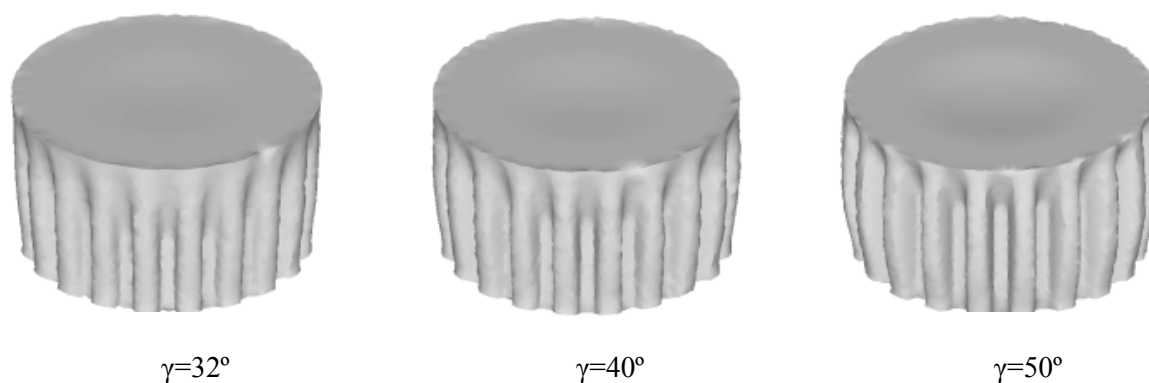
Рис. 2. Заповнення зубчастого профілю при видавлюванні з різними кутами конусу матриці
