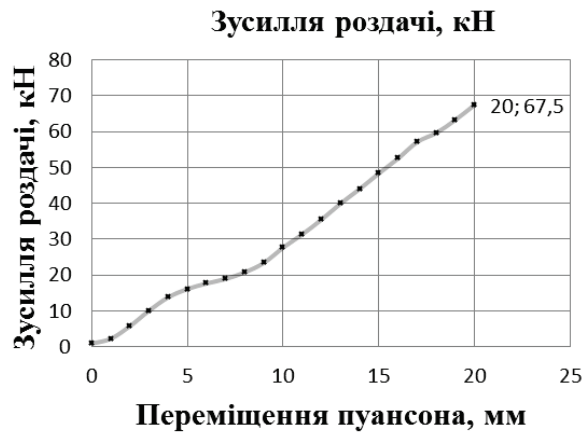
Рис.3. Залежність зусилля роздачі від переміщення пуансону.
