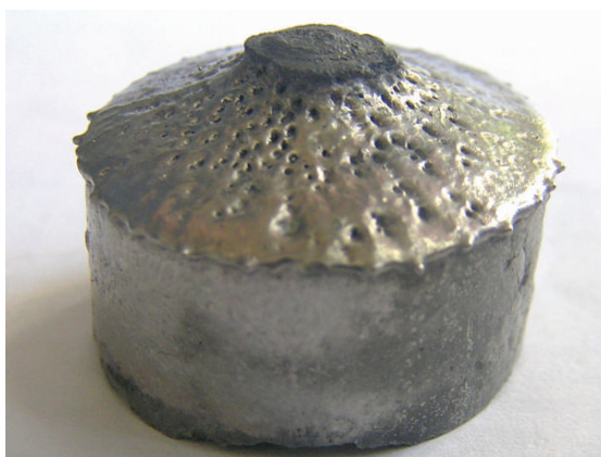
Рис. 1. Фрагмент литой заготовки релита после распыления ( \times 3,5 )
