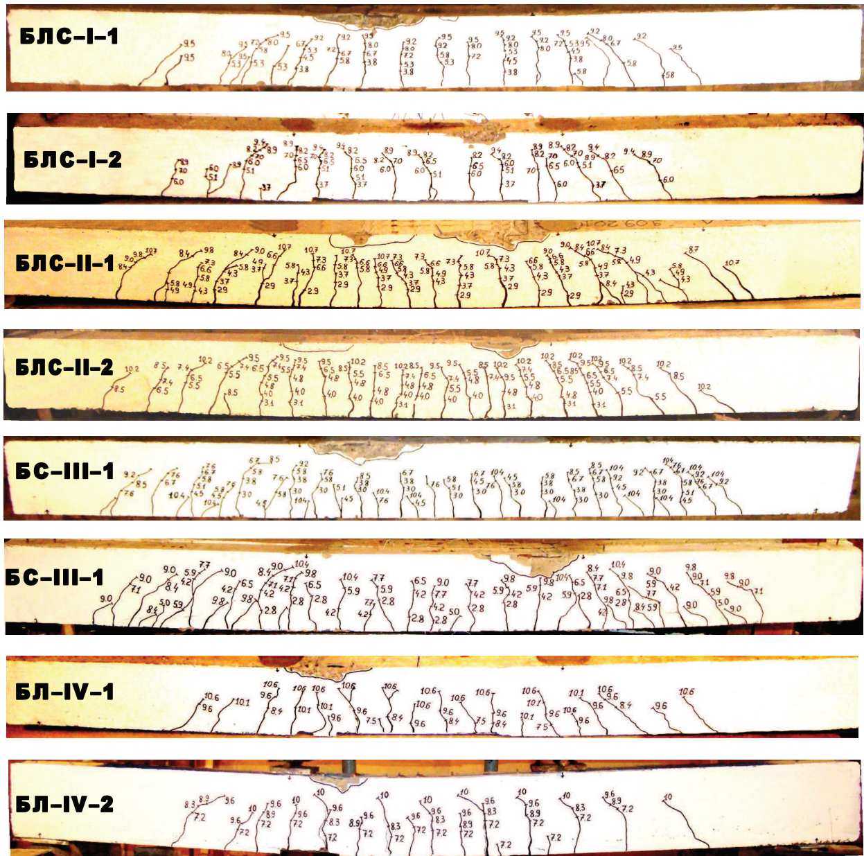
Рисунок 3 – Характер руйнування дослідних балок.
