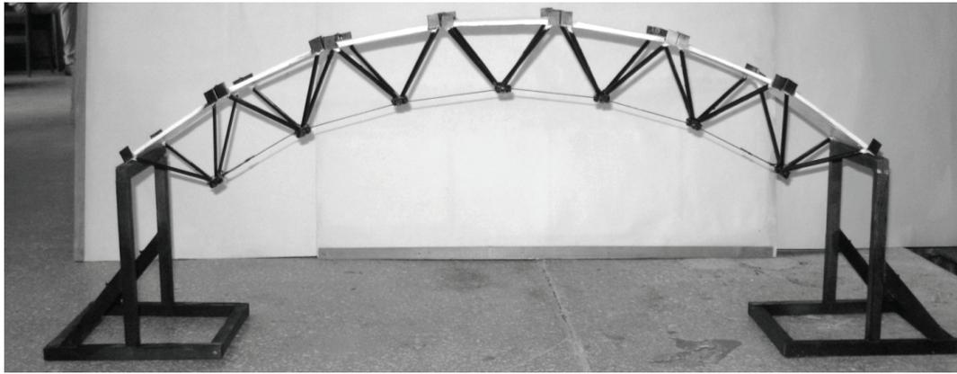
Рис. 4. Аркова секція покриття
