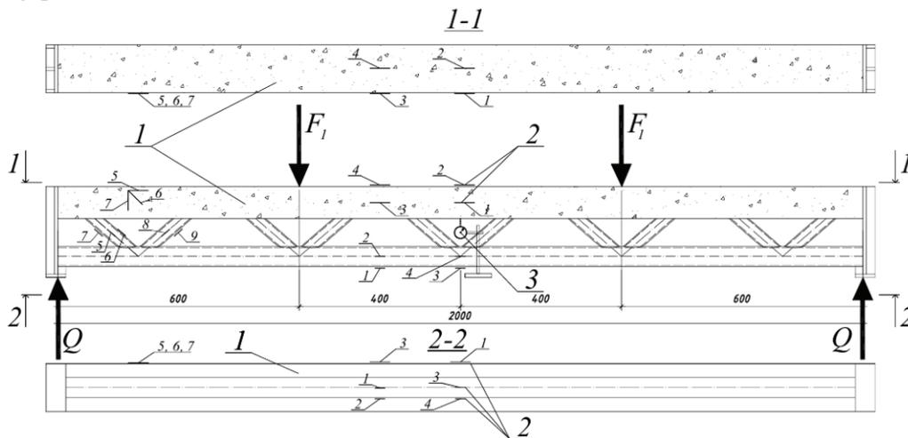
**Рисунок 3 – Схема розміщення тензорезисторів при випробуванні зразка: 1 – досліджуваний зразок; 2 – тензорезистори; 3 – прогиномір**
