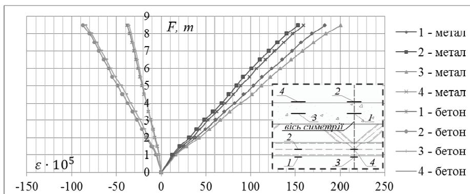
**Рисунок 4 – Деформації в нормальному перерізі, заміряні електротензорезисторами, розташованими по висоті перерізу**
