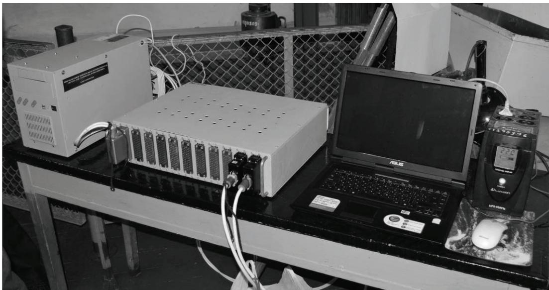
**Рисунок 2 – Багатоканальна вимірювальна тензометрична система для статичних випробувань ВНП-8**
