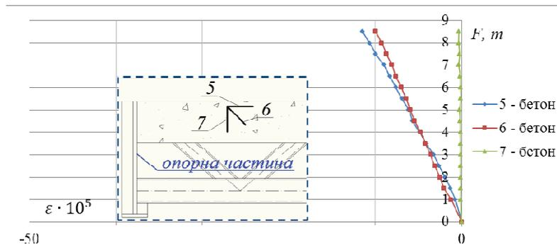
Рисунок 6 – Деформації балки заміряні електротензорезисторами (номери тензорезисторів 5-, 6-, 7- бетон)
