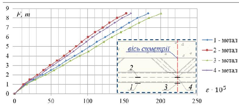
Рисунок 7 – Деформації балки заміряні електротензорезисторами (номери тензорезисторів 1-, 2-, 3-, 4- метал)
