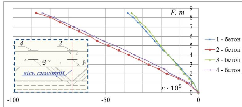
Рисунок 5 – Деформації балки заміряні електротензорезисторами (номери тензорезисторів 1-, 2-, 3-, 4- бетон)
