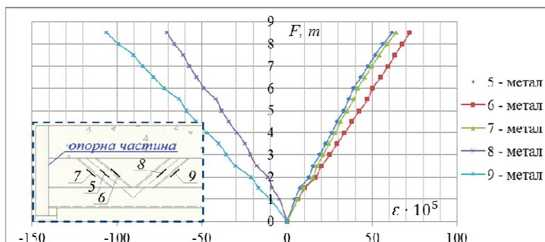
Рисунок 8 – Деформації балки заміряні електротензорезисторами (номери тензорезисторів 5-, 6-, 7-, 8-, 9- метал)
