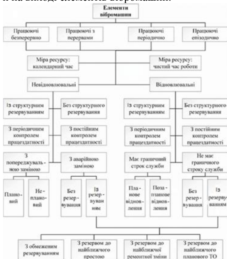
Рис. 2. Класифікація елементів вібромашин за режимами їх експлуатації
