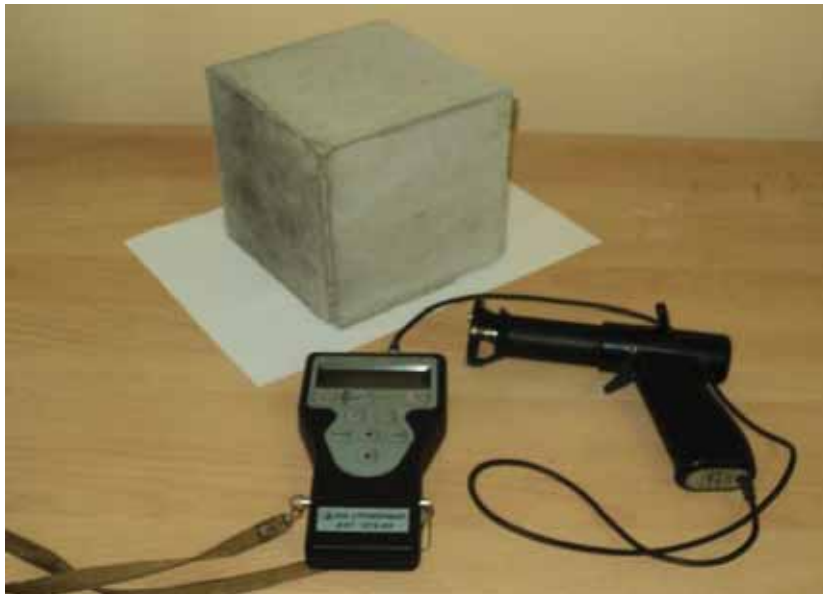
Рис. 1 – Визначення міцності на стиск за допомогою приладу ИПС-МГ- 4.03
