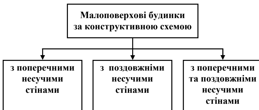
Рисунок 3 – Класифікація малоповерхових будинків за конструктивною схемою
