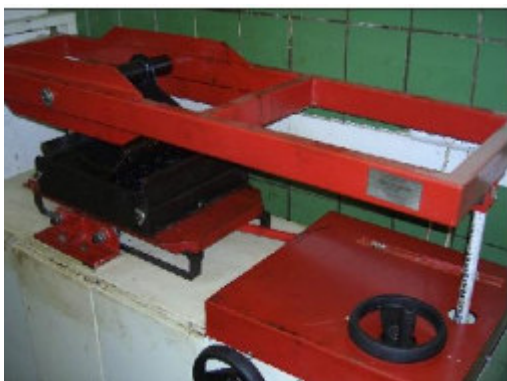
Рисунок 3 – Заформовані зразки асфальтобетону: а) прес секторний ПС-3С; б) форма з ущільненим зразком
