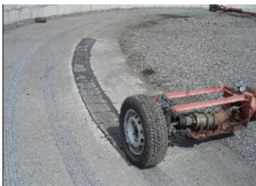
Рисунок 4 – Випробування зразків асфальтобетону
