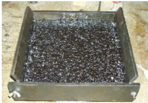
Рисунок 3 – Заформовані зразки асфальтобетону: а) прес секторний ПС-3С; б) форма з ущільненим зразком
