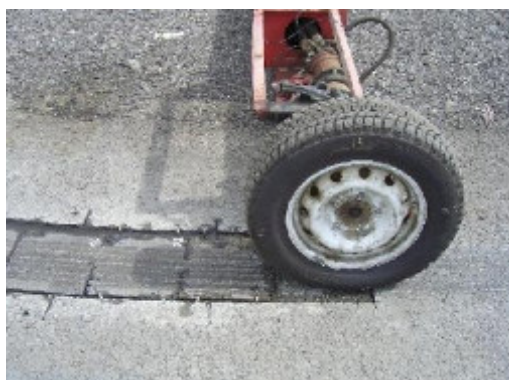
Рисунок 4 – Випробування зразків асфальтобетону
